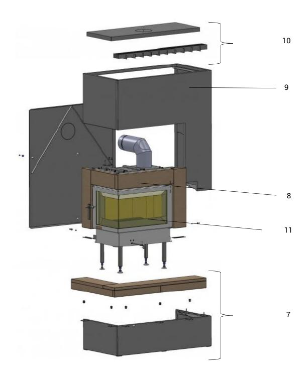
**Hinweis**: Bei der Installation ist der Mindestabstand von 400 mm von der Abdeckplatte zur Raumdecke einzuhalten. Der Kaminofen kann wandbündig vor nicht zu schützenden Wänden montiert werden.
