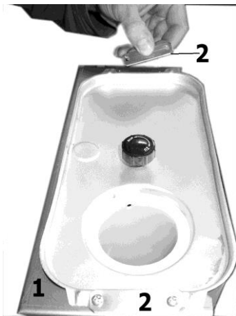
Abbildung 4: Montage der Tanksicherung 1 Tankbügel einschieben, 2 mit Tanksicherung und Blechschaube sichern.
