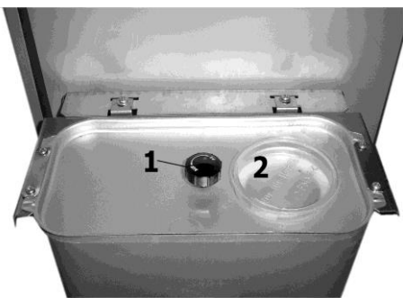
Abbildung 22: Öltank 1 Tankabsperrentil 2 Tanksteckdeckel
