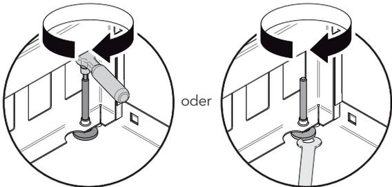
Anschließend die Befestigungsschrauben der Sockelblende lösen, Blende nach unten stellen (ca. 5 mm Spalt zum Fußboden) und die Befestigungsschrauben wieder festdrehen.
