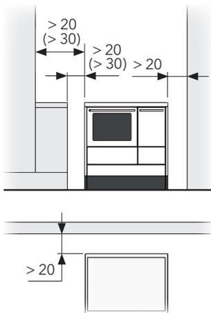
Bei Anbau an brennbare Materialien bzw. Einbau in eine Küchenzeile oder Anbau an einen E-Herd oder ein anderes Gerät ist eine Brandschutzeinheit (nachträglich oder fix montiert) vorzusehen. Maximale Höhe der angebauten Einrichtungsgegenstände entspricht hierbei der Herdhöhe. Einrichtungsgegenstände über Herdhöhe müssen mind. 20 cm (mind. 30 cm auf Rauchrohranschlussseite bei Geräten ohne Backrohr) entfernt sein.
