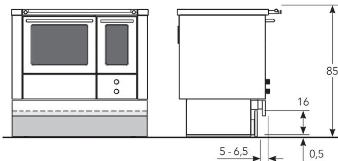
Die Sockelblendenbreite wird durch das Spaltmaß zum Küchensockel bestimmt.
