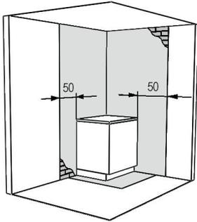
Der Sicherheitsabstand bei zu schützenden Gegenständen (z.B. brennbare Wände, Wände mit brennbaren Bestandteilen, Küchenhochschränke und tragende Wände aus Stahlbeton) ist mindestens 20 cm. Bei Geräten ohne Backrohr (LM 40 / LM 50) ist auf der Rauchrohranschlussseite ein Sicherheitsabstand von mindestens 30 cm einzuhalten.
