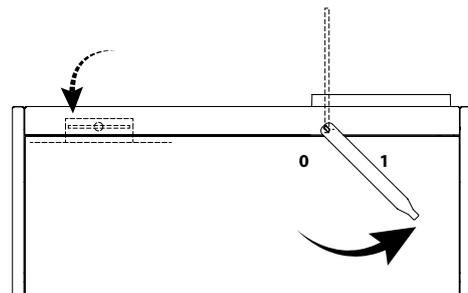
**Heiz- und Kochbetrieb:** Durchheizklappe schließen (mit Durchheizschlüssel auf 0 stellen) Abgasklappe wird automatisch geöffnet.
