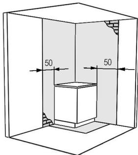
Der Sicherheitsabstand bei zu schützenden Gegenständen (z.B. brennbare Wände, Wände mit brennbaren Bestandteilen, Küchenhochschränke und tragende Wände aus Stahlbeton) ist bis Herdhöhe mindestens 5 cm (0 cm mit Brandschutzeinheit), darüber auf der Feuerraumseite mindestens 20 cm.
