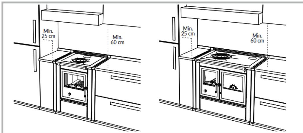
Abb. 3 – Mindestsicherheitsabstände für den Einbau mit eigens dazu bestimmten Abstandsverbindungen.
