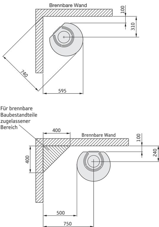
Für brennbare Baubestandteile zugelassener Bereich
