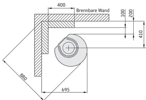
Für brennbare Baubestandteile zugelassener Bereich
