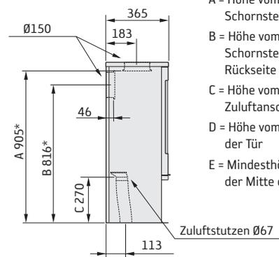
A = Höhe vom Boden bis zum Schornsteinanschluss an der Oberseite
