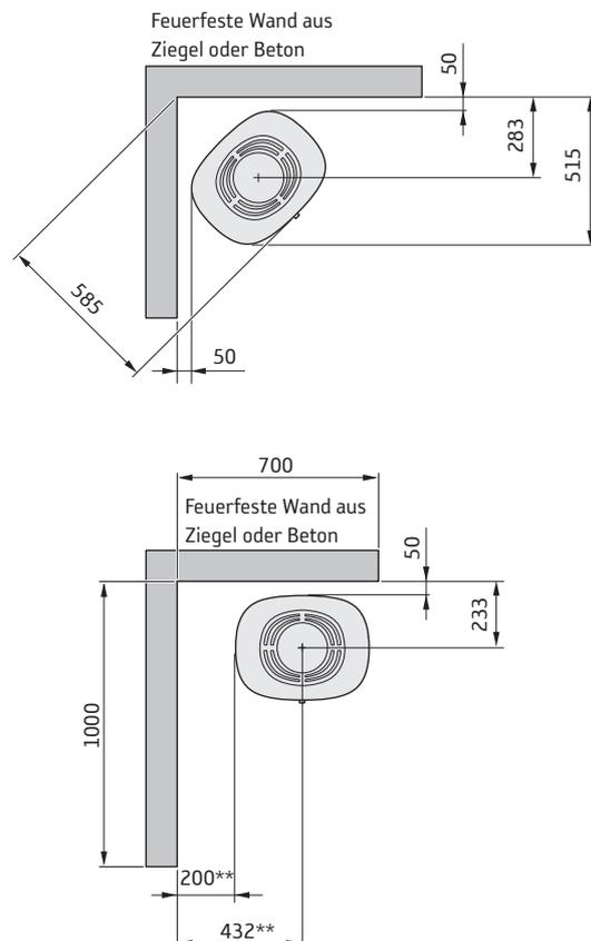
\* Wenn der Kaminofen auf einem Brandschutzbereich z.B. aus Glas (Zubehör) aufgestellt wird, ändert sich die Höhe vom Boden um die Stärke des Brandschutzbereichs. Ein freiliegender Brandschutzbereich aus Glas macht 10 mm aus.
