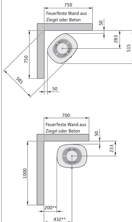
\* Wenn der Kaminofen auf einem Brandschutzbereich z.B. aus Glas (Zubehör) aufgestellt wird, ändert sich die Höhe vom Boden um die Stärke des Brandschutzbereichs. Ein freiliegender Brandschutzbereich aus Glas macht 10 mm aus.
