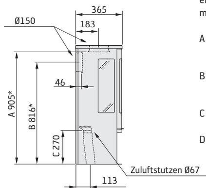
Der Mindestabstand zwischen Kaminofenöffnung und einem brennbaren Gebäudeteil oder Einrichtungsgegenständen beträgt 1,1 m.
