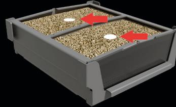
4. Die zwei Abdeckgläser auf die Pellet Box geben und diese in die Feuerstelle des Küchenherdes bis zum hinteren Anschlag einschieben. Zwischen den beiden Abdeckgläsern sollte mittig ein Spalt von ca. 2,5 cm sein.
