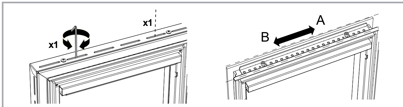
Figure 20 - Réglage auxiliaire de l'air pour la propreté de la vitre: la plaque est ouverte dans la position indiquée par la lettre A, tandis qu'elle est fermée dans la position indiquée par la lettre B.
