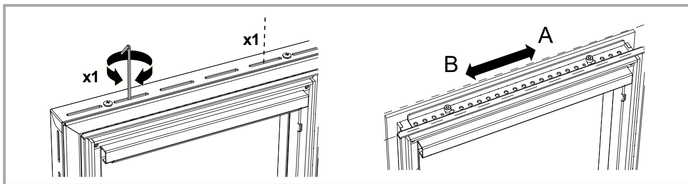
Figura 20 - Regolazione ausiliaria dell'aria per la pulizia del vetro: la piastrina è aperta in corrispondenza della posizione indicata con la lettera A, mentre è chiusa in corrispondenza della posizione indicata con la lettera B.
