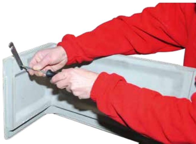
12. Verbindungslasche mit Schraube M 6 x 20 mm am linken Seitenteil montieren.
