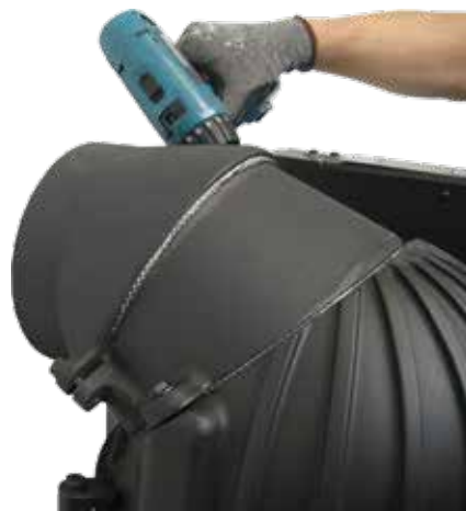
10. Abgaskuppel für waagerechten oder senkrechten Anschluss montieren.
