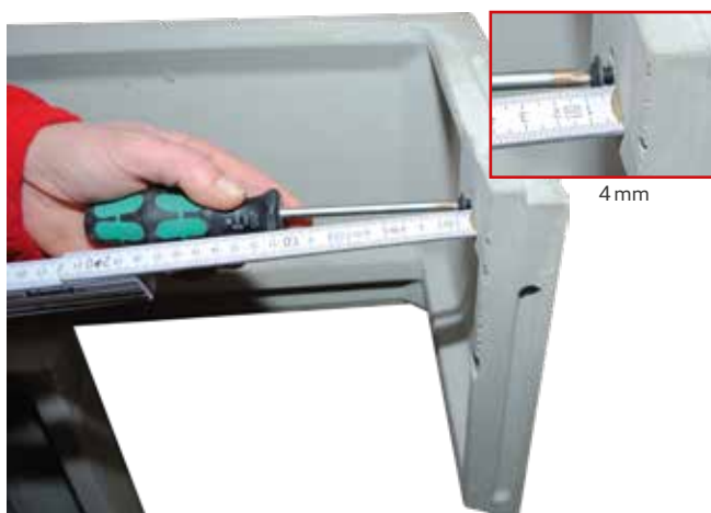
11. Schraube M 6 x 20 mm für hintere Fixierung am rechten Seitenteil oben im Abstand von 4 mm eindrehen.
